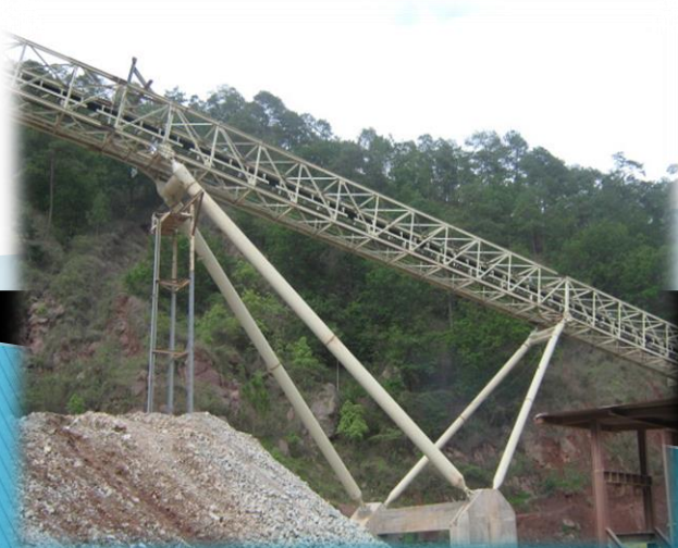
Montaje de 800 Mts de Banda Transportadora en Proyecto expansión Aura Minerals, Minerales de Occidente. Octubre 2009 – Marzo 2010
